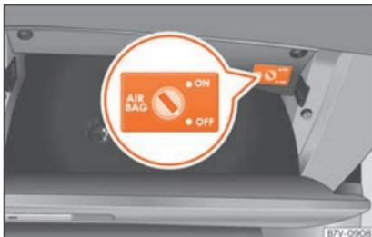
**Fig. 29** Dans la boîte à gants, côté passager : commande à clé pour activer et désactiver l'airbag frontal côté passager.
