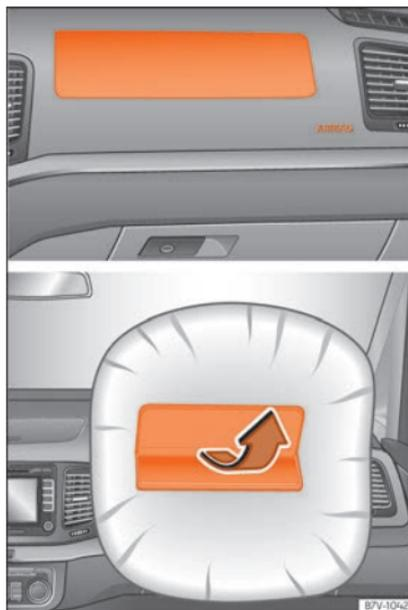
**Fig. 28** Emplacement et champ d'action de l'airbag frontal du passager avant.
