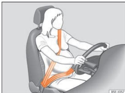
**Fig. 90** Ajustement recommandé de la sangle de ceinture de sécurité pour les femmes enceintes.
