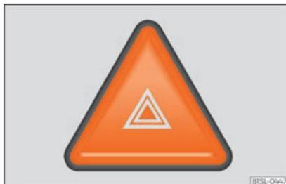
**Fig. 144** Au centre de la planche de bord : touche des feux de détresse.
