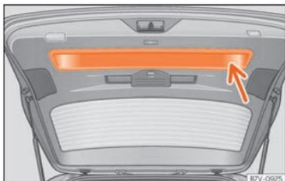
**Fig. 139** Hayon arrière ouvert : cavité pour tirer.
