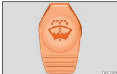
**Fig. 60** Dans le compartiment moteur : bouchon du réservoir de liquide lave-glacé.
