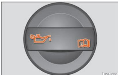
**Fig. 292** Dans le compartiment moteur : bouchon de l'orifice de remplissage de l'huile moteur.
