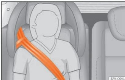
**Fig. 98** Siège intégré pour enfants : parcours de la sangle de la ceinture avec poignée de guidage.
