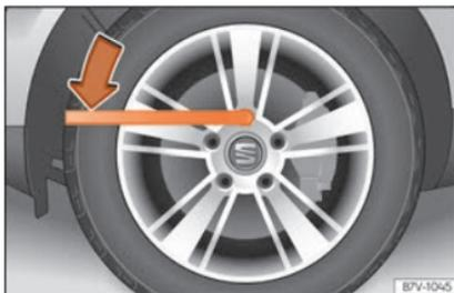
**Fig. 69** Change de roue : desserrer les boulons de la roue.
