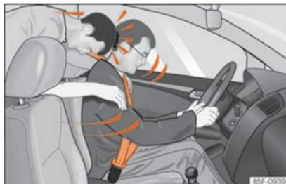
**Fig. 88** Le passager arrière n'ayant pas bouclé sa ceinture est projeté en avant et vient heurter le conducteur qui a bouclé sa ceinture.
