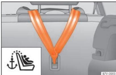
**Fig. 40** Ceinture de fixation supérieure accrochée dans le coffre.
