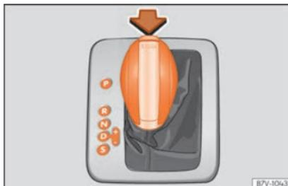
**Fig. 51** Boîte automatique : positions du levier sélecteur.
