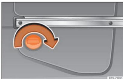
**Fig. 288** Dans la partie arrière gauche du coffre : réservoir d'AdBlue, derrière un couvercle.
