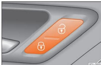
Fig. 4 Sur la porte du conducteur : touche de verrouillage centralisé.
