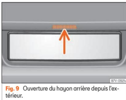
**Fig. 9** Ouverture du hayon arrière depuis l'extérieur.
