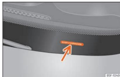
Fig. 304 Numéro d'identification du véhicule.
