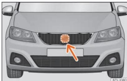
**Fig. 259** Sur la face du véhicule derrière l'emblème SEAT : capteur radar.
