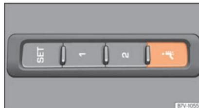
Fig. 160 Sur le côté du siège avant : touche de fonction du massage lombaire.
