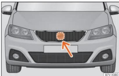
**Fig. 263** Sur la face du véhicule derrière l'enseigne SEAT : capteur radar.
