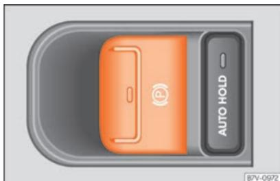
**Fig. 239** Détail de la console centrale : contacteur du frein de stationnement électronique.
