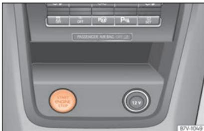
**Fig. 237** Dans la console centrale : bouton de démarrage du système de fermeture et démarrage sans clé Keyless Access. Sur les véhicules avec le volant à droite, le réglage est symétrique.
