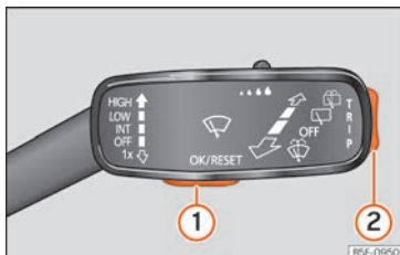
Fig. 126 Levier d'essuie-glace : touches de contrôle.
