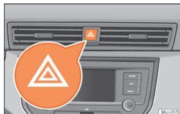
Fig. 43 Planche de bord : commande des feux de détresse.
