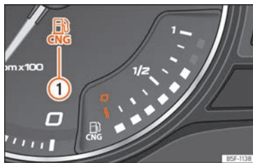
Fig. 123 Tableau de bord analogique : indicateur du niveau de gaz naturel
