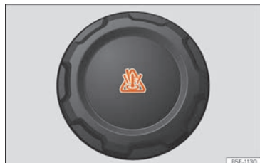
Fig. 60 Compartiment-moteur : bouchon du vase d'expansion du liquide de refroidissement.
