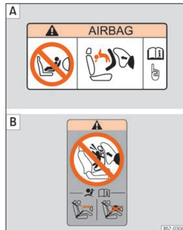
Fig. 31 Autocollant de l'airbag - version 2 : sur le pare-soleil côté passager [A] et sur le cadre arrière de la porte du passager [B].
