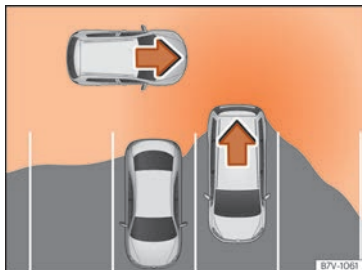
Fig. 246 Représentation schématique de l'assistant de sortie de stationnement : zone surveillée autour du véhicule sortant de stationnement.
