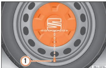
Fig. 70 Placement correct de l'enjoliveur central de roues pour jantes en acier.
