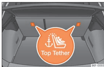
Fig. 34 Position des anneaux Top Tether sur la partie arrière de la banquette arrière.
