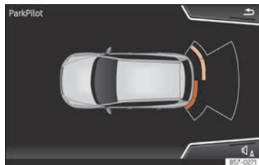
Fig. 259 Affichage de l'aide au stationnement à l'écran du système Easy Connect.
