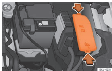
Fig. 64 Dans le compartiment moteur : cache du boîtier de fusibles.
