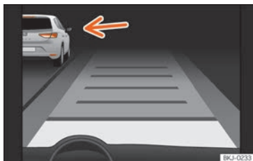
Fig. 239 Sur l'écran du combiné d'instruments : ACC activé, véhicule circulant à gauche détecté
