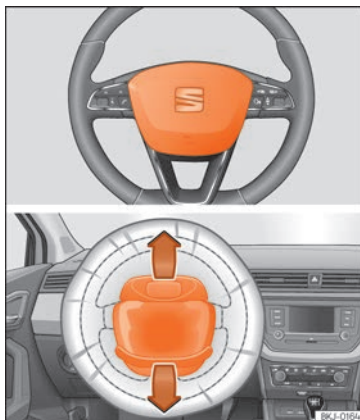
Fig. 22 Airbag du conducteur dans le volant.
