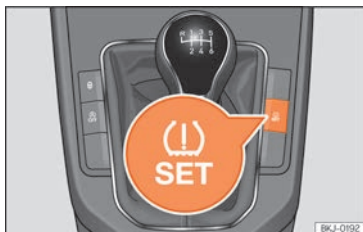
Fig. 286 Console centrale : touche du système de contrôle de la pression des pneus.
