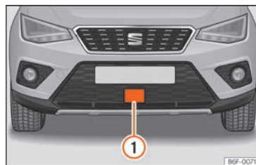
Fig. 236 Au niveau du pare-chocs avant : capteur radar.
