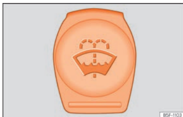
Fig. 62 Dans le compartiment moteur : bouchon du réservoir de liquide lave-glace.
