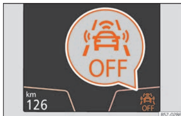
Fig. 232 Sur l'écran du combiné d'instruments : indication de Front Assist désactivé.
