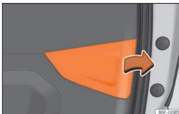
Fig. 109 Hayon arrière ouvert : retirer le cache.
