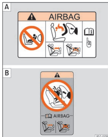
Fig. 30 Autocollant de l'airbag - version 1 : sur le pare-soleil côté passager [A] et sur le cadre arrière de la porte du passager [B].
