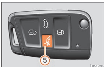
Fig. 132 Clé du véhicule avec bouton d'alarme.
