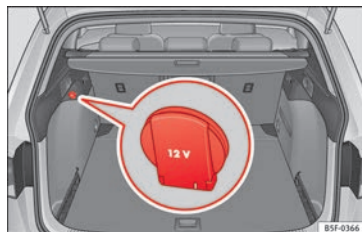
Fig. 159 Détail du revêtement latéral du coffre à bagages : prise de courant de 12 volts (valable uniquement sur le modèle LEON ST).
