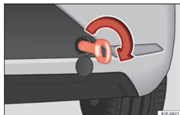
Fig. 76 Pare-chocs arrière droit : œillet de remorquage vissé
