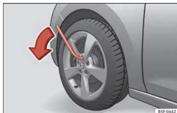
Fig. 72 Roue : desserrer les vis de roue.
