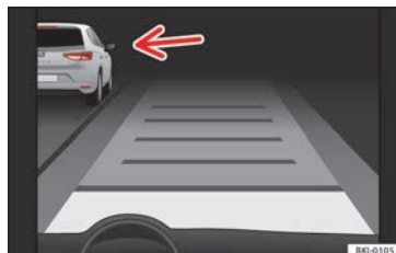
Fig. 208 Sur l'écran du combiné d'instruments : ACC activé, véhicule circulant à gauche détecté
