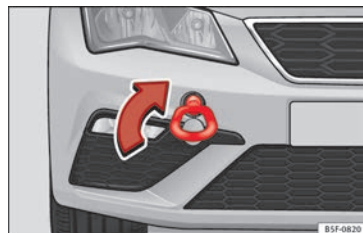
Fig. 75 Pare-chocs avant droit : œillet de remorquage vissé
