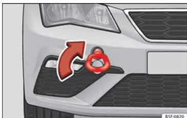
Fig. 97 Pare-chocs avant droit : œillet de remorquage vissé
