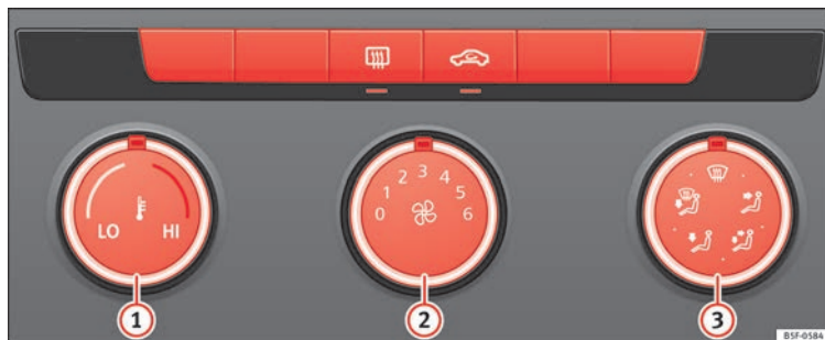
Fig. 57 Dans la console centrale : commandes du système de chauffage et d'air frais.
