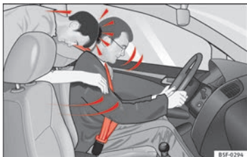
Fig. 90 L'occupant de la banquette arrière non attaché est projeté en avant et vient heurter le conducteur attaché.
