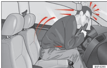
Fig. 89 Le conducteur n'ayant pas bouclé sa ceinture est projeté en avant.
