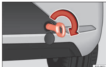
Fig. 99 Pare-chocs arrière droit : œillet de remorquage vissé
